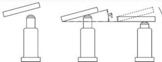
スライド嵌合はしないで下さい。ピン先端のメッキ削れが発生し、接触抵抗不良の原因となります。
